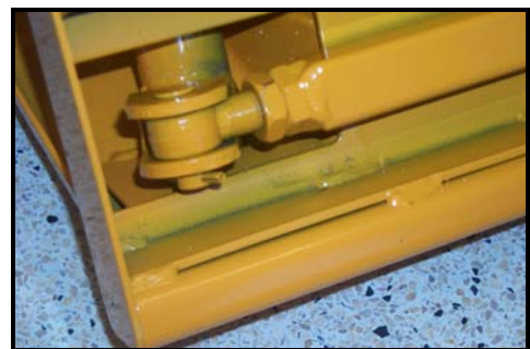
Photo 2 - Contre-écrou serré contre l'écrou soudé
