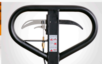
Sens de marche sélectionné par le réglage de la poignée sur la barre d'attelage
